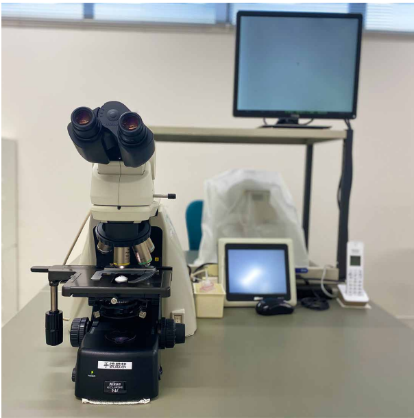
図3 1000倍まで観察可能な光学顕微鏡とディスプレイ
