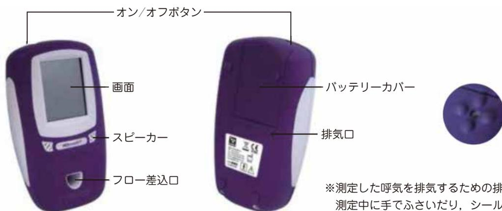
※測定した呼気を排気するための排気口。測定中に手でふさいだり、シールなどでふさがないように注意する。
