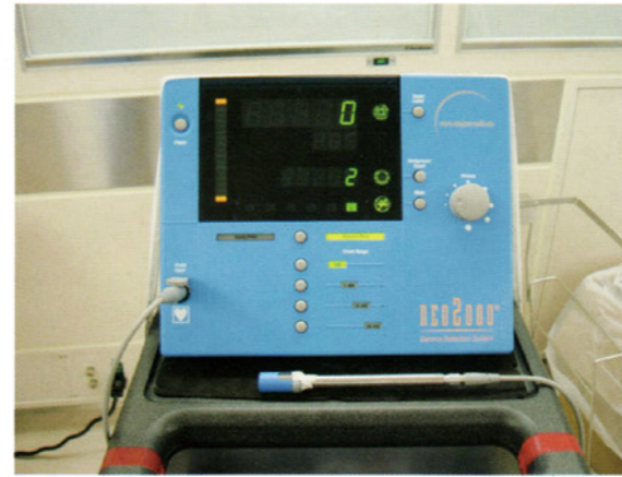
2 当院で使用している高感度 \gamma 線検出装置指向性に優れている。
